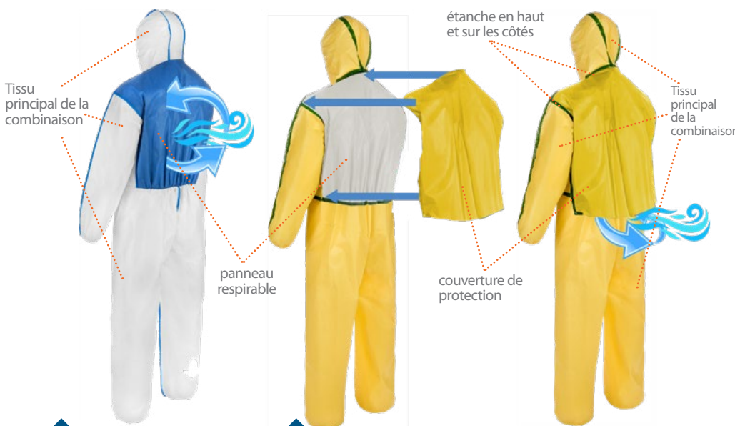
MicroMAX® NS Cool Suit - Type 5 et 6 MicroMAX® TS, ChemMAX® 1 (illustré ci-dessus), ChemMAX® 3, Pyrolon™ CRFR Cool Suits - Type 4
